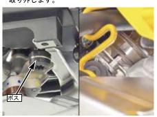
〇ノーマルエアクリーナーのコネクティング チューブよりホースバンドを取り外し、 ①エアフィルター COMP. のコネクティング チューブに取り付けます。
