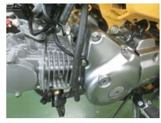
〇エアクリーナーケースより吸気温度センサー を取り外します。
