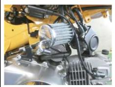
○クランクケースから繋がっているノーマルの ブリーザーホース、チューブを切断し、④異径ホースコネクター、③ホースクランプ を用いエアフィルターと接続します。 取り回し、各ホース、チューブ長さは画像を 参考にして下さい。
