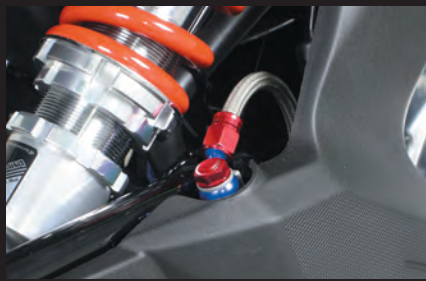
ブレーキホース取付け部(マスターシリンダー側)
