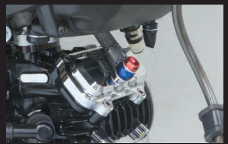
弊社製スーパーヘッド4V+Rシリンダーヘッドのインスペクションブリーザーカバーに接続可能
