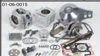
■ストロークアップクランクシャフト(106cc:50mm/124cc:54mm) ※ボア&ストロークアップキット用
