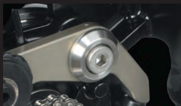
テンショナーアーム振れを 制御する専用カラー採用
