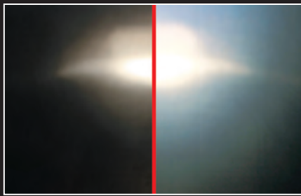
ノーマルヘッドライトによる輝度比較 右:LEDフォグランプ無し 左:LEDフォグランプ点灯
