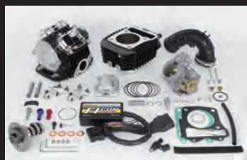
スーパーヘッド4V+R(5軸ポート加工)コンボキット181cc (ビッグスロットルボディー付属) (01-05-0169)
