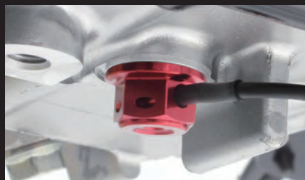
ドレンボルトにスティック温度センサーを接続
