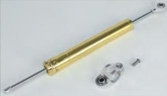
従来品ステアリングダンパーの形状、減衰力、ストローク、調整範囲すべてを見直し、最適な仕様を求めたステアリングダンパーです。各車種専用ステアリングダンパーステーを使用し、車両に装着することで、ハンドルの揺れや路面からのキックバックを吸収し、走安性が向上します。減衰力特性とフリクションロス低減によりスムーズな作動を実現し、高負荷時には適切なダンピングが得られます。汎用性を考慮し、ストロークを125mmに設定しました。減衰力調整はボディ一体型ダイヤル式を採用。ステアリングダンパーのシェルボディはアルミ材を精巧に削り出し、表面にシャンパンゴールドアルマイトを施しています。付属のピロボール付きダンパーホルダーはアルミ削り出しシルバーアルマイトを採用。ボディ、ホルダー共に弊社ロゴのレーザーマーキング入り
