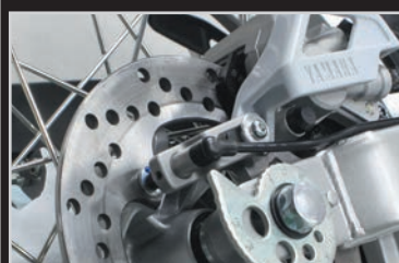
金属反応式スピードセンサー (付属品)
