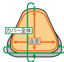
座面の寸法 350mm×320mm
