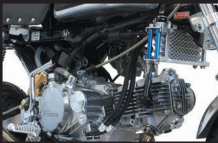
装着写真(4フィン5オイルライン)
