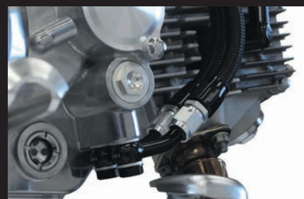
装着写真(オイル取り出し口)
