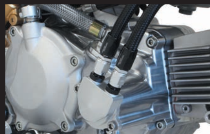
装着写真(オイル取り出し口)
