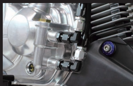
装着写真 (オイル取り出し口)
