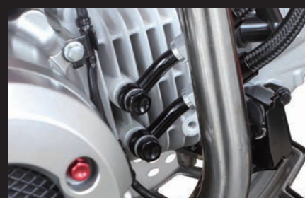
装着写真(オイル取り出し口)
