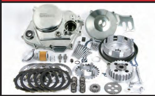
スペシャルクラッチは5ディスクの強化クラッチを採用しており、ノーマルよりクラッチ容量を大幅にアップさせることでクラッチの滑りを防止します。又、クラッチにはスタンダードクラッチと高回転時のシフトダウンによる急激なエンジンブレーキのショックを緩和させるスリッパークラッチの2種類があります。ダイカストクラッチカバーはサーモスタットの取付け可能な特許取得構造を採用し、オイルクーラーへのオイル取出し口、オイル点検窓、オイルフィルターを装備。ダイカストクラッチカバー：アルミニウム製ハレル研磨仕上げ
