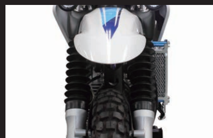
装着写真 (3フィン4オイルライン)
