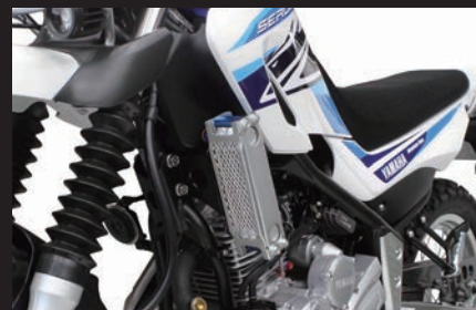
装着写真 (3フィン4オイルライン)
