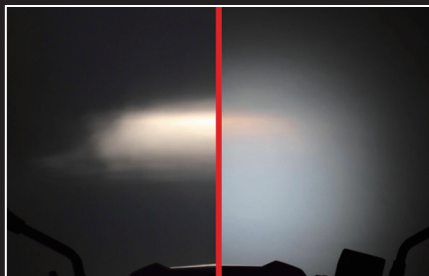
ノーマルヘッドライトによる輝度比較 左:LEDフォグランプ無し 右:LEDフォグランプ点灯
