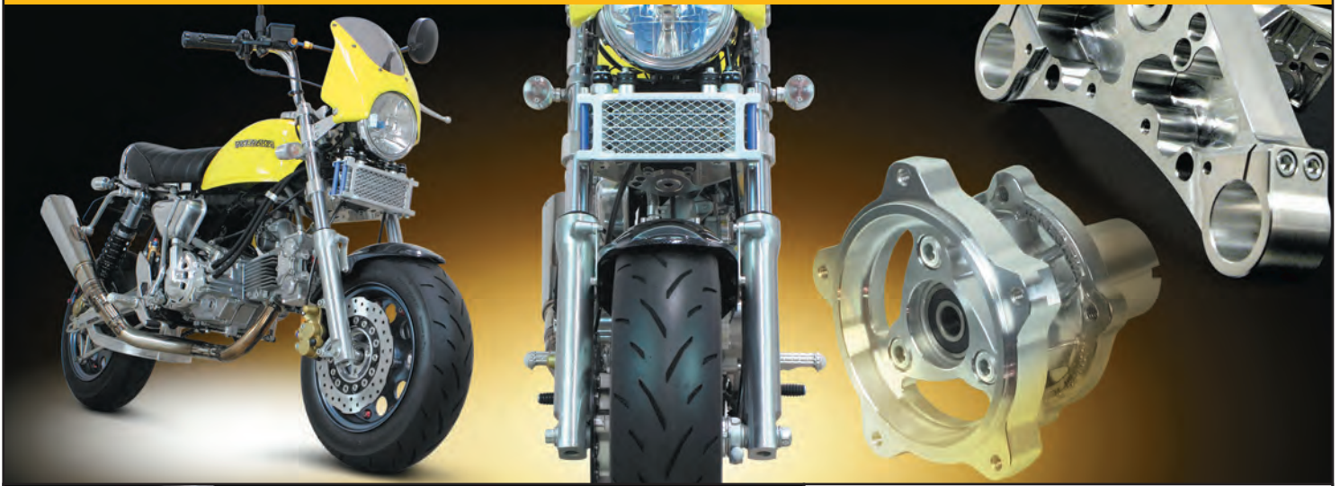
■10インチ用Φ30フロントフォーク フォーク長A:564mm フォークオイル量:128cc フォークオイル粘度: #15
