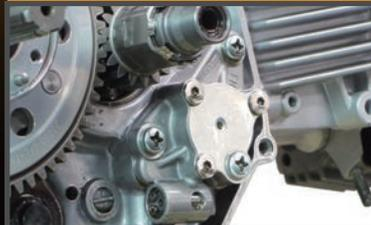
SP武川製スーパーオイルポンプは吐出量を純正比で増加し、不安定なアイドル時の油圧確保と回転上昇に伴う油圧の変化に対応する為、オイルラインに一定の油圧に達した時のみバルブが開く、リリーフバルブ機能を設置しております。
