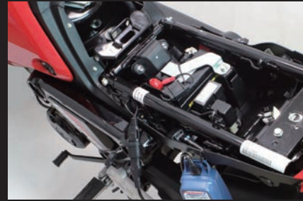
コンフォートアイレットによる充電器接続
