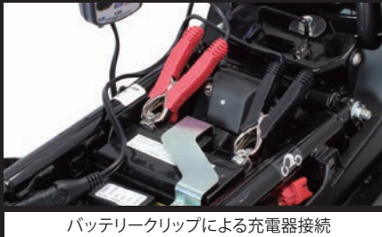
バッテリークリップによる充電器接続
