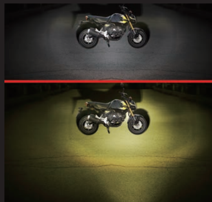
ノーマルヘッドライトにフォグランプ1灯有無の比較 上:無し / 下:有り(1灯乗車時右装着)
