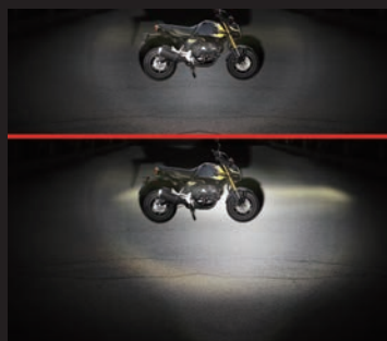
ノーマルヘッドライトにフォグランプ1灯有無の比較 上:無し/下:有り(1灯乗車時右装着)
