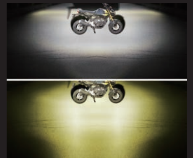
ノーマルヘッドライト+フォグランプ2灯 上:ホワイト(Hi側)/下:イエロー(Lo側)
