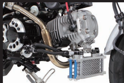
4フィン5オイルライン装着写真
