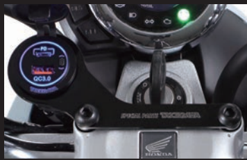
ブルーLEDバックライト内蔵 USBポートの視認性が向上
