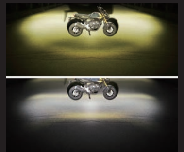
ノーマルヘッドライト+フォグランプ2灯 上:イエロー (Hi側)/下:ホワイト (Lo側)
