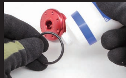
オイルフィルターキャップ装着時、Oリングに使用
