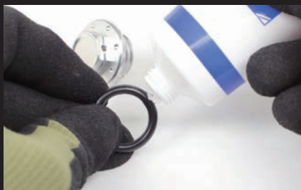
ジェネレータープラグ装着時、Oリングに使用
