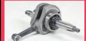
振動低減、及びピックアップの向上を目的としたバランスカットを行い軽量化。クランクシャフトへの応力が増加するジャーナル部は特殊ヘアリングを採用し、シャフト径を純正の20mmから22mmにサイズアップし強度を向上しました。
