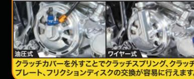
クラッチカバーを外すことでクラッチスプリング、クラッチプレート、フリクションディスクの交換が容易に行えます。
