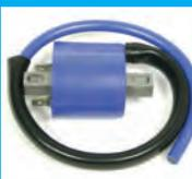
全回転域の放電電圧を向上させ、燃焼効率を向上。エンジン高回転時の放電電圧の低下やプラグコード、スパークプラグの劣化が原因となる失火に対し強い威力を発揮。装着によるノーマルコンピューターへの影響もありません。
