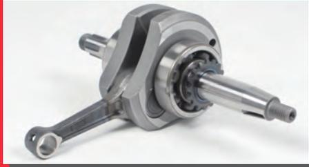
振動低減、及びピックアップの向上を目的としたバランスカットを行い、軽量にしています。クランクシャフトへの応力が集中するジャーナル部は特殊ベアリングを採用し、シャフト径を純正の20mmから22mmにサイズアップし強度を高めました。
