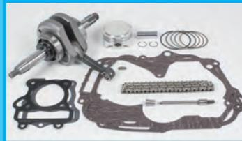
Rステージ88ccキット装着車が106ccへと排気量アップを行うキットです。シリンダーヘッド、カムシャフト、シリンダーはそのまま使用し、本製品の組付で、106cc化が行えます。
