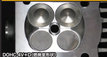
DOHC 4V+D (燃焼室形状)
