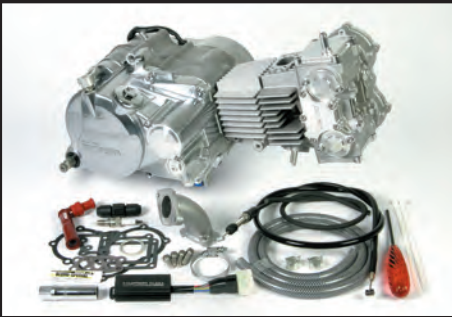
セカンダリー式キックスターシステムクランクケース 湿式スペシャルクラッチ (アルミダイカスト製パフ研磨クリア塗装)
