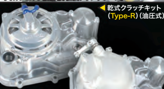
乾式クラッチキット(Type-R)(油圧式)
