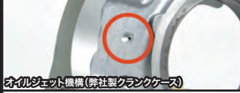
オイルジェット機構(弊社製クランクケース)
