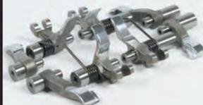
ロッカーアーム(強制開閉式機構)
