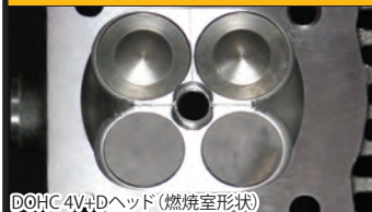
DOHC 4V+Dヘッド(燃焼室形状)
