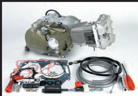
DOHC4V+D コンプリートエンジン138cc プライマリー式キックスターターシステムクランクケース スペシャルクラッチ 5ディスク (湿式) /ワイヤー式
