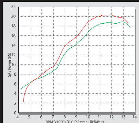
DOHC4V+D コンプリートエンジン138cc プライマリー式キックスターターシステムクランクケース スペシャルクラッチ 5ディスク (湿式) /ワイヤー式
