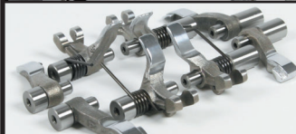
ロッカーアーム(強制開閉式機構)
