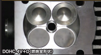
DOHC 4V+D(燃焼室形状)
