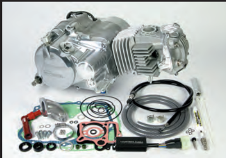
セカンダリー式キックスターシステムクランクケース 123cc 湿式スペシャルクラッチ (アルミダイカスト製バフ研削クリア塗装)
