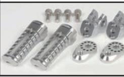
アルミ削り出しステップバー、ブラケットにはアルマイトが施されています。ステップの固定位置の変更により、7ポジションから選択することが可能です。対象車両:レブル250(MC49-1000001~)
