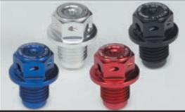
エンジンオイルに混ざった鉄粉をドレンボルトに設けたマグネットが強力な磁力で吸着します。脱落防止用ワイヤーロック穴とSP武川製スティック温度センサー差込穴を備えています。SP武川製コンパクトLEDサーモメーター(スティック温度センサー付き)、又はサーモメーター付き各種メーターを別途ご購入頂くことでドレンボルト部での温度を計測することが出来ます。ドレンボルト本体はアルミ材を精巧に削り出し、表面にカラーアルマイトを施しています。マグネットには磁力が強力なネオジムマグネットを採用。対象車両:CL250(MC57-1000001~):CL500(PC68-1000001~)
