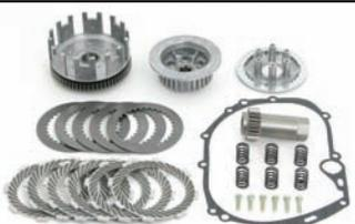
ノーマルクラッチ(5枚ディスク)に対し、6枚ディスクに変更することにより、クラッチ容量がアップする為、スプリングのセット荷重を低く設定することが出来る(ノーマルスプリングとの組合せにより)、クラッチ操作を軽くすることが可能です。
