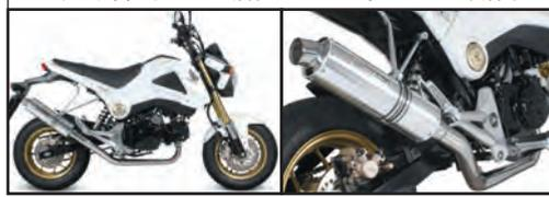
φ90アルミサイレンサーを採用。マフラーはダウンタイプで1ピース構造を採用。
