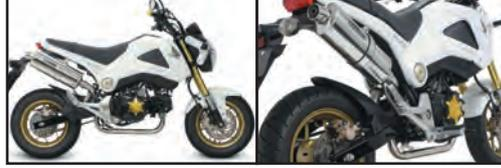
サイレンサー/エキゾーストパイプ共に耐久性に優れたステンレス材を採用し、表面にポリッシュ研磨を施しています。マフラーはアップタイプで2ピース構造を採用しています。
