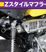
ノーマルヒートガードの取付けが可能でノーマルスタイルを崩さないアップマフラーです。高出力エンジンに対応する「Type-2」や弊社製DOHC4V専用用もあります。
