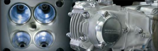
88cc/106ccのHシリンダーはアルミ製スリーブシリンダー。106cc/125cc/138cc/124ccはメッキシリンダー。弊社製シリンダーには弊社製M5温度センサーの取付けが可能。138ccは別途C1アダプターが必要。詳細はWEBカタログをご覧ください。
