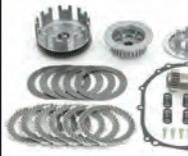
ノーマル(5枚)に対し、6枚ディスクにすることでクラッチ容量をアップする為、スプリングのセット加重を低く出来る(ノーマルスプリングとの組み合わせにより)、クラッチ操作を軽くすることが可能です。クランクシャフトの回転を100%二次側クラッチに伝達し、スロットルレスポンスを向上させるプライマリドライブギアが付属。強化スプリングが付属。ケーブル配合アプリケーションディスクを採用。強化スプリングが付属。
