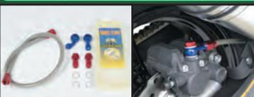
ノーマルマスターシリンダー、ノーマルキャリパーに対応。メッシュホースに変更することで、ブレーキタッチが向上します。ホースにはコーティングを行い、干渉部の擦れ傷を防ぎます。フィッティング部、ハンジョーボルト、ハンジョーはカラーアルマイト仕上げ 対象:Z125 PRO(BR125H-A02621~)
