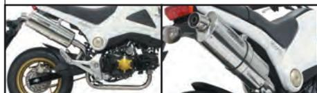
サイレンサー/エキゾーストパイプ共に耐久性に優れたステンレス材を採用。表面にポリッシュ研磨を施しています。マフラーはアップタイプで2ピース構造を採用。対象:GROM(JC61-1000001~1299999) 近接騒音:79dB(A) ※政府認証はノーマルエンジンに限ります。
