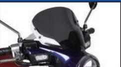
ヘッドライトの上部にバイザーを固定することで、風防効果を発揮することが出来ます。これにより、走行時の空気抵抗によるライダーの疲労を軽減出来ます。純正部品のようなフィット感の為、スーパーカブC125の流麗なスタイルを崩すことなく、取付けることが出来ます。又、ノーマルフロントカウルに合わせたバイザーのカットラインと曲面がドレスアップ効果を高め、車両を美しく演出します。バイザーは高品質なポリカーボネイト製で、精神的雰囲気が増えるスモーク仕様を採用。固定用ステーはスチール製ブラック塗装仕上げ ※固定用ステー取付けの際、バックミラーベース部のラバー切断加工が必要になります。
