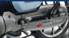
ノーマルのチェーンケースキャップと交換するだけの為、特別な作業の必要もなく簡単にドレスアップすることが出来ます。弊社製チェーンケースホールプラグは、アルミ材を美しく削り出し、表面にアルマイトを施しています。又、中央には弊社のロゴがレーザーマーキングされています。アルマイトのカラーはシルバー、ブラック、レッドの3種類からお選び頂けます。Oリング付属。
