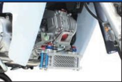
弊社製5ステージボアアップキット181cc装着車が対象となるオイルクーラーキットです。本製品はシリンダーヘッド下に付属のオイルクーラーステーを取付け、オイルクーラー本体を固定します。オイルクーラーへのオイル取出しは、弊社製5ステージボアアップキット181ccに採用されているオールアルミセラミックシリンダーのオイル取出しホースを使用します。オイルクーラー本体の段数は3フィン4オイルラインです。別途カーレーサーセット(07-07-0208)をご購入で、アルミ削り出しタペットカバー(01-18-1038~1040)との同時装着が可能です。
