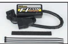
噴射時間の調整は増量最大5000µs、減量最大7500µsとなっております。ノーマル排気量からボアアップ車両まで幅広くご利用頂けます。パソコン、スマートフォンを用いてエンジン回転数、エンジン温度、スロットル開度、インジェクター開閉率のモニタリング機能を搭載しておりますのでセッティング時にも非常に便利に使用して頂けます。
