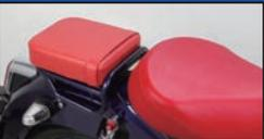
リアキャリアに装着することでパッセンジャーへの快適性と安全性を高めることが出来ます。又、シート本体にはパッセンジャーの姿勢確保の為、ベルトを装備。シート表皮にはラウチの表面をモチーフにデザインを採用し、ブラックとレッドの2種類からお選び頂けます。シート内部に耐振動性、クッション性に優れた特殊スポンジを採用。これにより走行中の疲労が軽減され、快適なライディングをお楽しみ頂けます。
