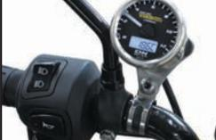
本製品は純正ハンドルに対応するクラブステア、車両専用サブハーネスが付属している為、純正部品の加工や配線加工の必要が無く、取付け出来ます。配線はメインハーネスにあるサービスカプラーに専用サブハーネスを使用し、カプラーオンで接続します。
