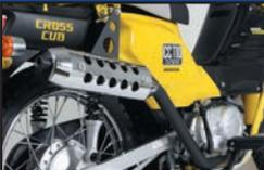
トルキングスタイルをイメージしたアップタイプのスポーツマフラーです。サイレンサー、エキゾーストパイプは共にスチール製を採用し、表面にブラック塗装が施されています。
