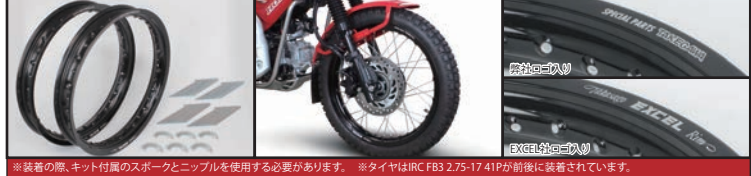
※装着の際、キット付属のスポークとニップルを使用する必要があります。 ※タイヤはIRC FB3 2.75-17 41Pが前後に装着されています。
